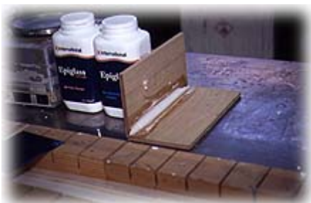
Der Radius der Kehle sollte das drei- bis fünffache der Materialstärke betragen.
