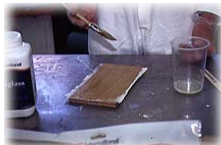
Die letzte Schicht dick auftragen, noch freiliegende Gewebefasern antupfen.
