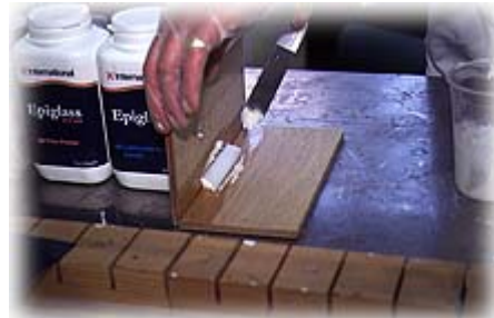
Masse mit gerundetem Spachtelbrett in die zu verbindende Ecke einstreichen.
