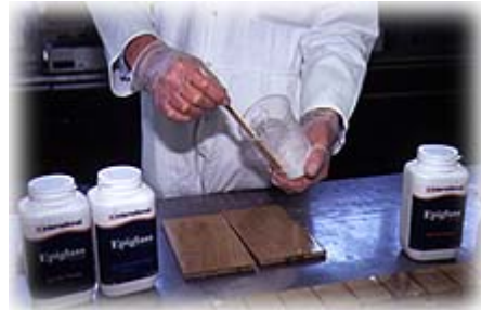
Aus Harz, Härter, Klebepulver und Füller sorgfältig eine Klebemischung anrühren.
