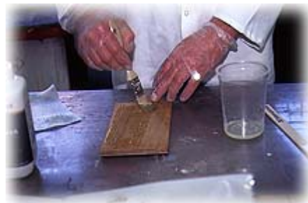
Untergrund versiegeln und erste Epoxidschicht genügend dickklebrig auftragen.
