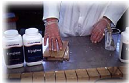
Die Klebeverbindung benötigt keinen hohen Druck; leichtes Festdrücken reicht.
